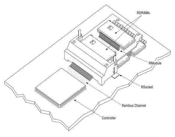
Fig. 1 Rambus Subsystem
