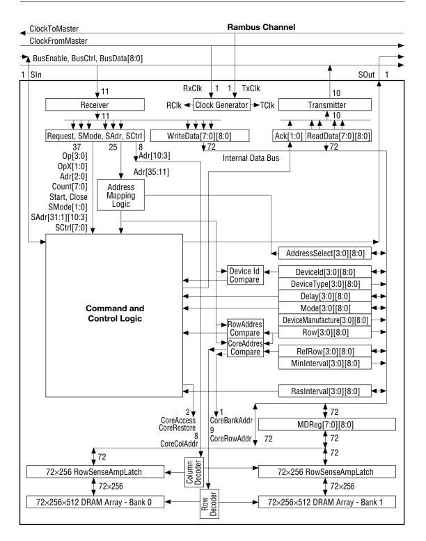
Fig. 13 RDRAM Block Diagram
